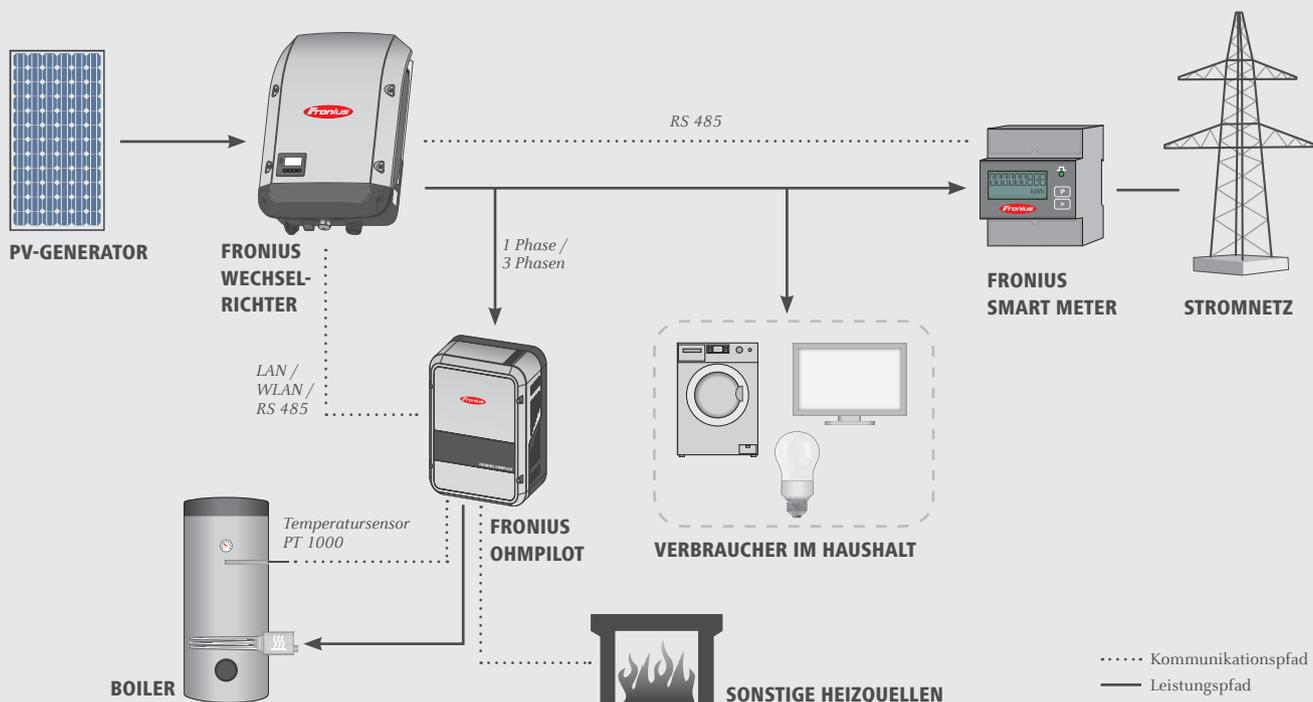
/ Bei der Installation punktet der Fronius Ohmpilot mit einfacher Inbetriebnahme über die eigene Website sowie mit einfacher Kommunikationsanbindung über WLAN. Gleichzeitig schützt der Fronius Ohmpilot durch die saubere und störfreie Ansteuerung der Verbraucher das Stromnetz, damit sind Sie als Installateur für die Anforderungen von heute und morgen gerüstet.
