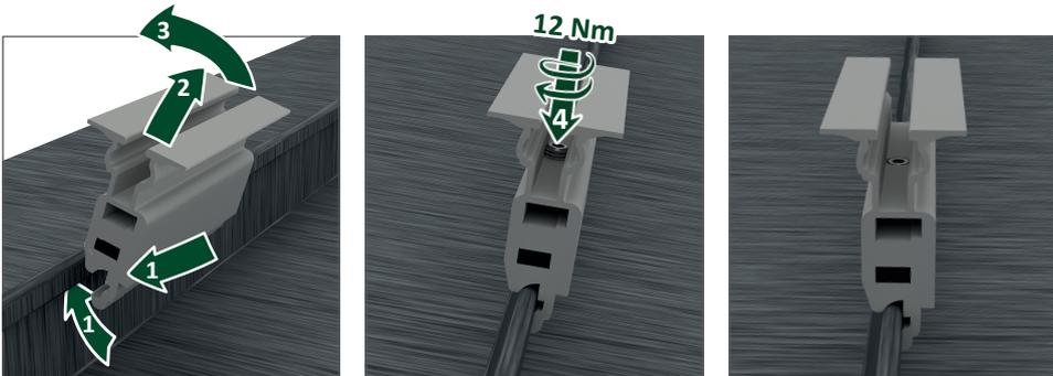
1. Klemme falzseitig von schräg unten direkt am Bördelfalz ansetzen und einhaken
